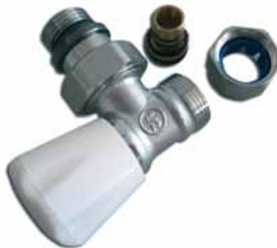
Válvula de radiador con adaptador para PEX 16x1,8 mm.
